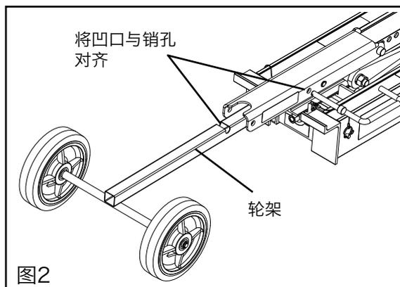
2. 将轮架滑入管中，直到轮架上的凹口与销钉孔对齐（图2）。
