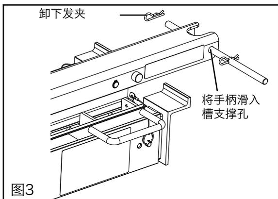
4. 卸下一个发夹，将手柄滑入Flex-Lifter运输车的另一端的槽支撑孔，然后重新插入发夹（图3），将手柄安装好。
