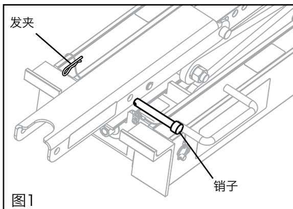
1. 从Flex-Lifter™运输车一端的槽形支架上卸下销子和发夹（图1）。
